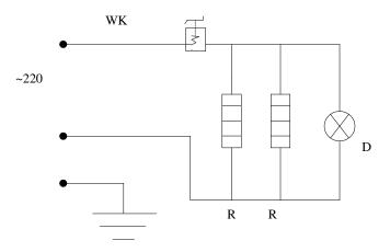
R1-R2-Нагревательная трубка D-Нагревательная лампа WK1-Термостат
