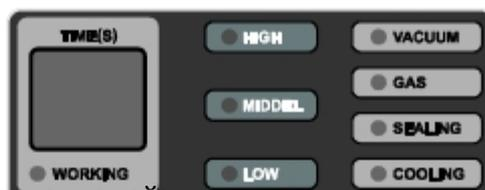
Рисунок 4.3 - Расположение таймера и индикаторов панели управления
