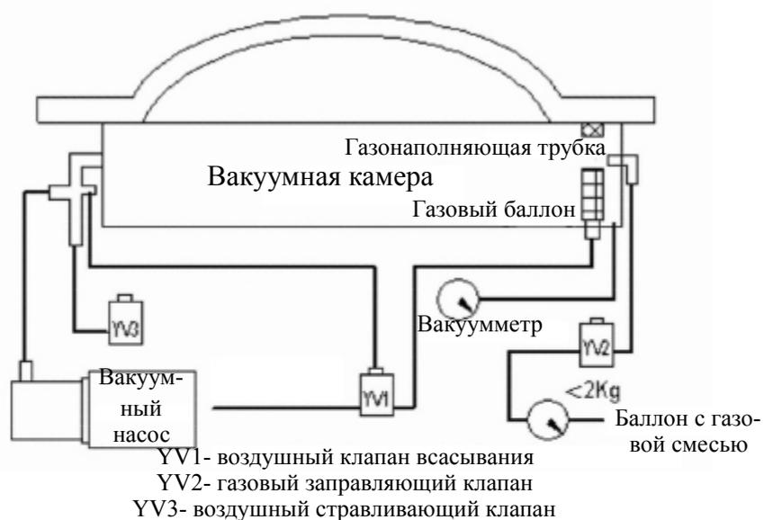
Схема вакуумного упаковщика с системой газации
